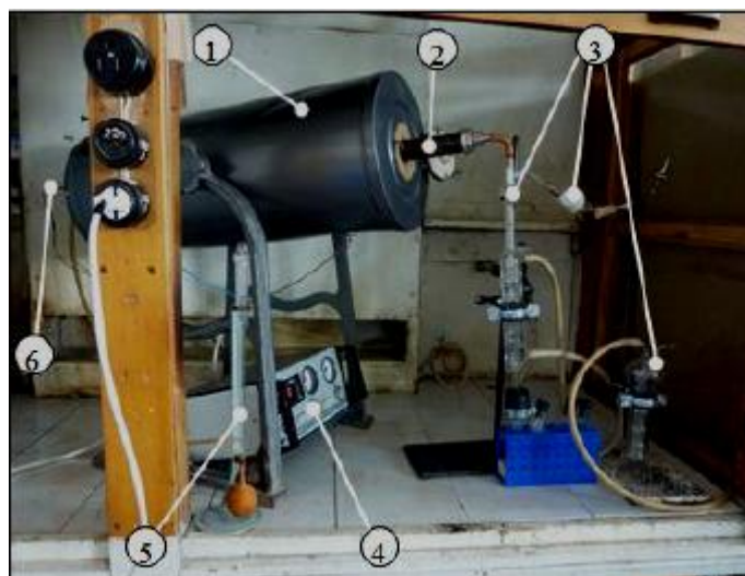
1 – трубчатая печь; 2 – реактор-пиролизер; 3 – система охлаждения и газоочистки; 4 – блок управления; 5 – пенный расходомер; 6 – датчик температуры
