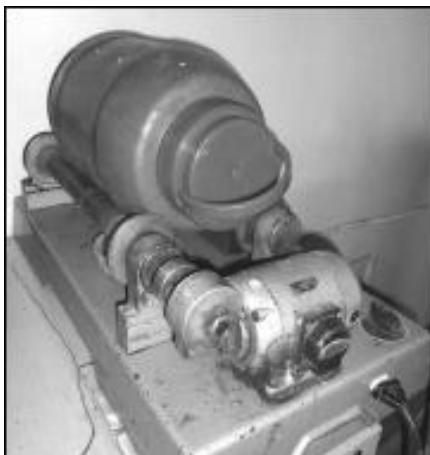
Рисунок 2 – Фотография лабораторного барабанного гранулятора для получения гранул
