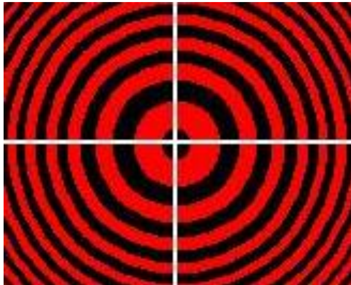
Рис.4. Интерференционная картина от сплошного фотоупругого датчика в условиях «полное сцепление»
