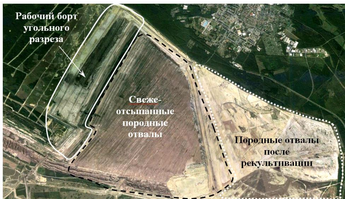
Рис. 1. Фрагмент космоснимка с изображением горных работ на угольном разрезе «Вайсвассер» (Восточная Германия)
