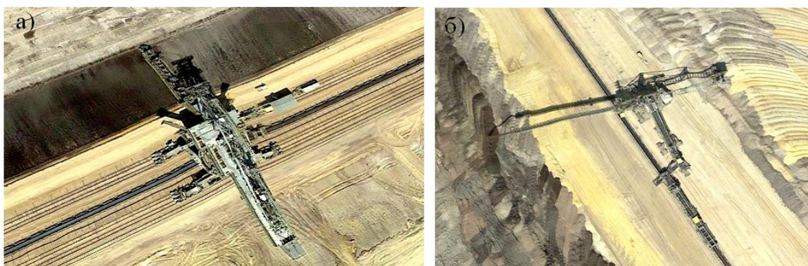
Рис. 3. Фрагменты горных работ по подготовке угольных пластов к выемке: а – цепной экскаватор непрерывного действия; б – отвалообразователь на отсыпке вскрышных пород
