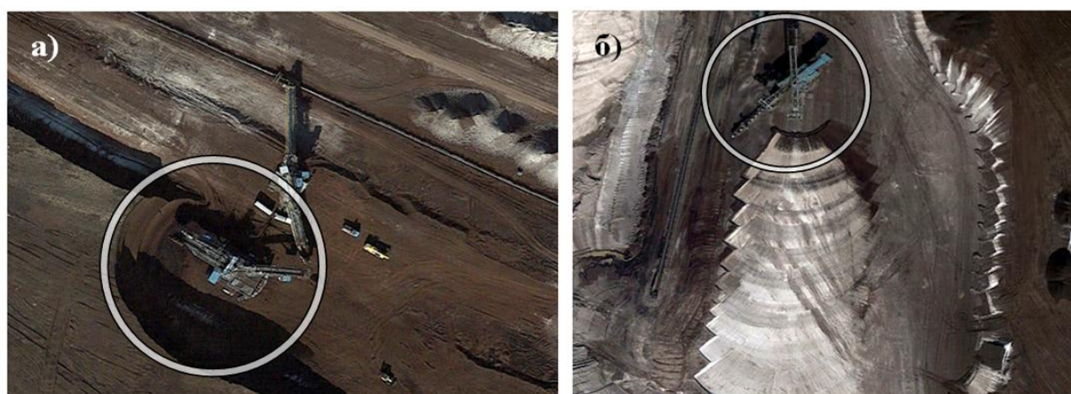
Рис. 4. Фрагменты добычных работ из космоса: а – забой роторного экскаватора; б – отработка угольного пласта цепным экскаватором нижним черпанием
