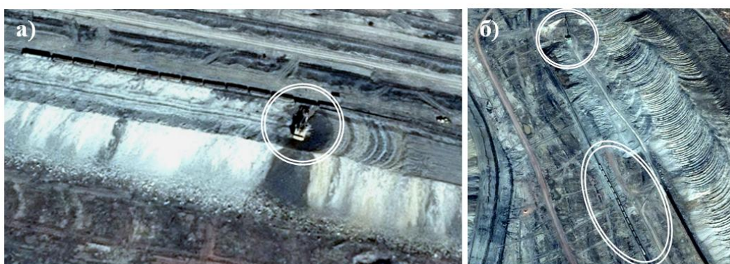
Рис. 3. Горные работы по отсыпке вскрышных пород в отвалы из космоса на разрезе «Бородинский»: а – укладка вскрышных пород экскаватором ЭКГ-10; восточный сектор внутреннего отвала с драглайном ЭШ-10/70
