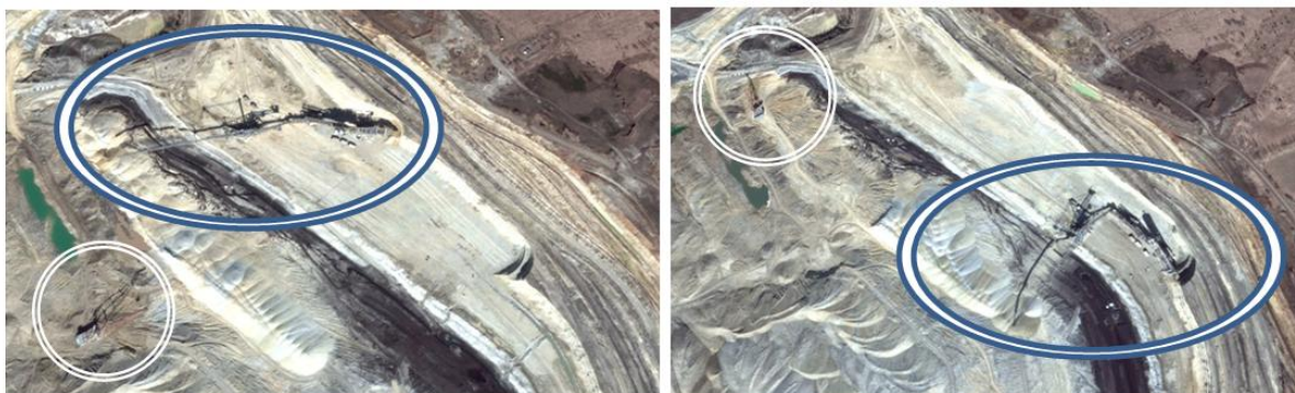
Рис. 4. Роторный экскаватор CRS(k)-4000 с отвалообразователем на отработке вскрышного уступа высотой 35 м из космоса (разница в положении 10 дней)
