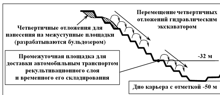
Рис. 6. Схема нанесения рекультивационного слоя при переходе на комбинированную технологию рекультивации
