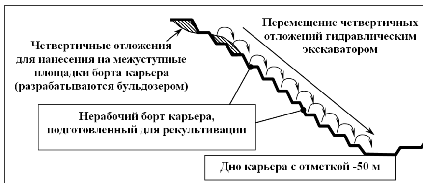
Рис. 4. Схема перемещения рекультивационного слоя в технологиях рекультивации нерабочего борта щебеночного карьера
