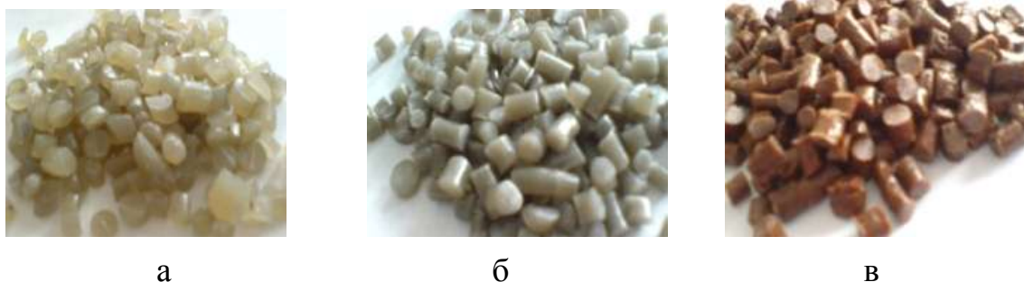
Рис. Объекты исследования: а – гранулят вторичного полиэтилена; б, в – вторичный полиэтилен наполненный 10 % тальком и охрой
