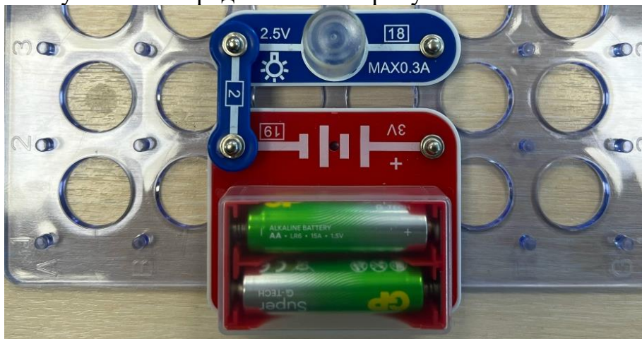
Рис. 1. Схема тестера электропроводимости на конструкторе «Знаток»
