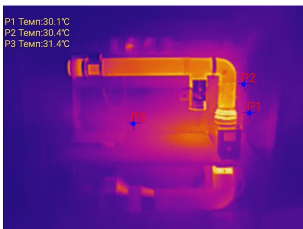
Рисунок 3 – Пример изображения установки с воздуходувкой потока нагреваемого воздуха
