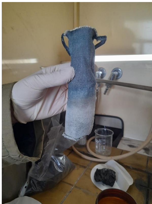
Рисунок 2. Анод в виде сборника топлива в формате второй конфигурации
