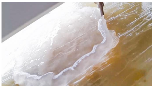
Рисунок 1 – Трёхмерная печать объекта гидрогелем
