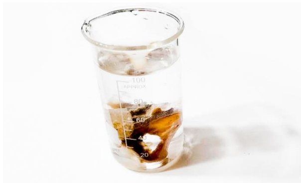
Рисунок 3 – Высушенный расслоенный образец, погружённый в воду
