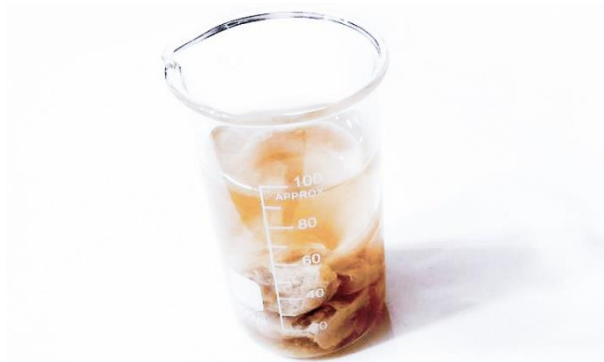
Рисунок 4 – Расслоенный образец спустя 24 часа после погружения в воду
