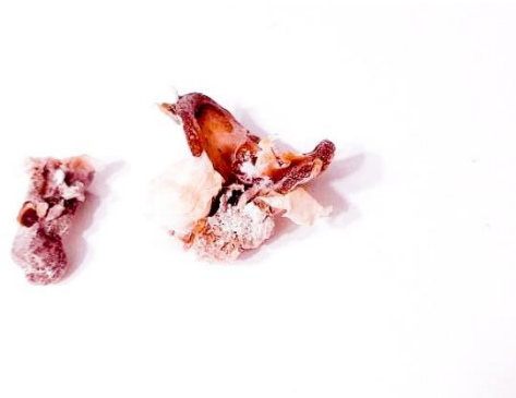
Рисунок 2 – Высушенный расслоенный образец напечатанного изделия из гидрогеля
