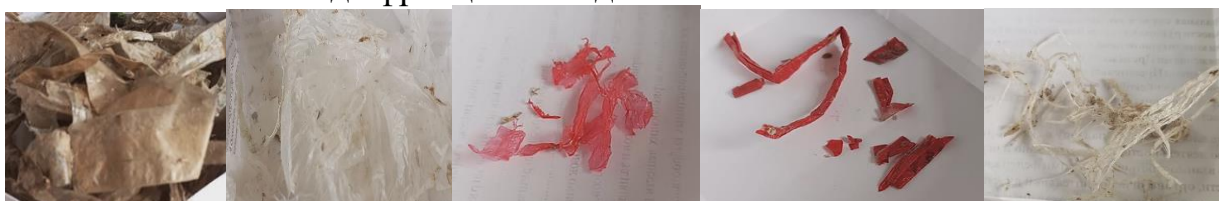
Рис. 2. Образцы полимеров из всплывшей фракции отхода
