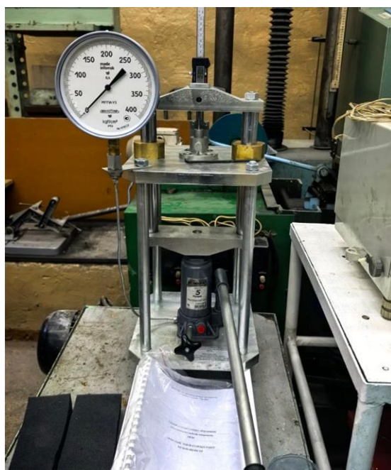
Рис. 4. Установка модели МСМ примененная при проведение испытаний на растяжение
