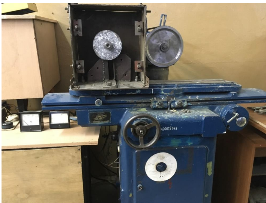
Рис. 3. Внешний вид установки для испытаний шлифовальных кругов на механическую прочность
