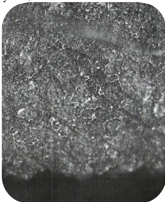
Рисунок 2 — Карбидная сетка на микроструктуре цементованного слоя образца стали марки 12Х2Н4А (увеличение \times 500 )
