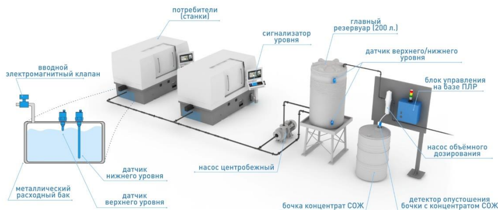
Рисунок 1 – Схема автоматизированной системы приготовления и подачи СОЖ для станков с ЧПУ
