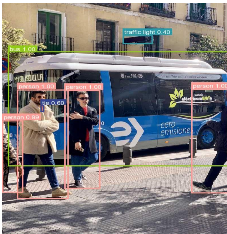
Рисунок 4. Работа модели Faster R-CNN ResNet50 FPN v2
