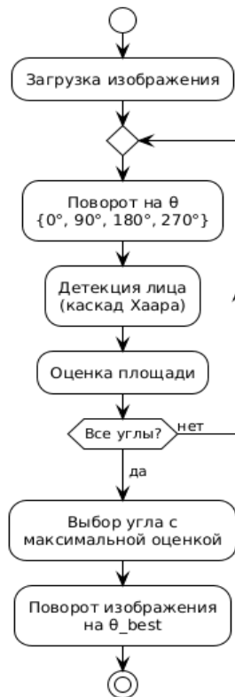
Рисунок 1 — Этап 1 метода автоматической ориентации документов на основе каскадной детекции лиц: грубая ориентация изображения документа.
