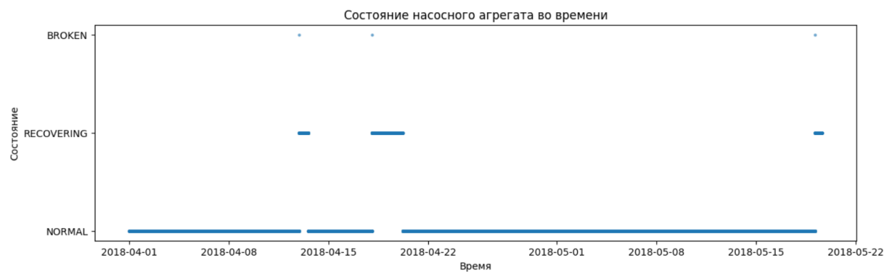
Рисунок 1 – Изменение состояния насосного агрегата во времени Как видно из рисунка №1, наблюдения формируют непрерывный временной ряд, в котором доминирует состояние NORMAL, а переходы в RECOVERING и особенно в BROKEN встречаются существенно реже. Это подтверждает целесообразность рассмотрения набора данных как основы для прогнозирования технического состояния во времени.
