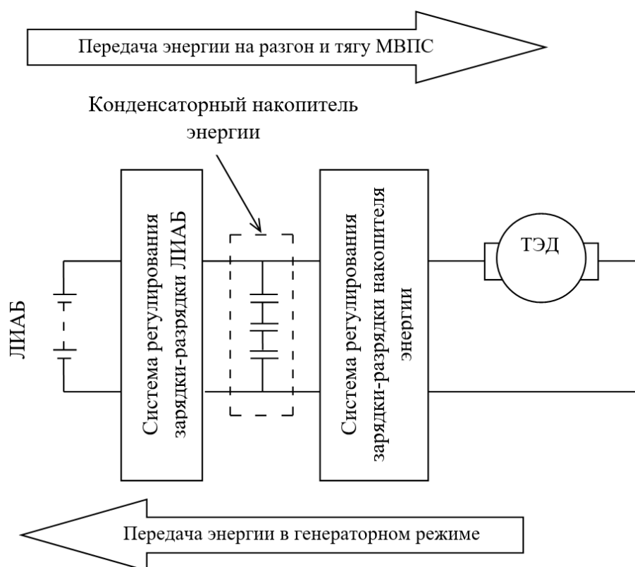
Рисунок 1 – Структурная схема рекуперативного торможения электропоезда ЭД9М с аккумуляторно-конденсаторными накопителями энергии
