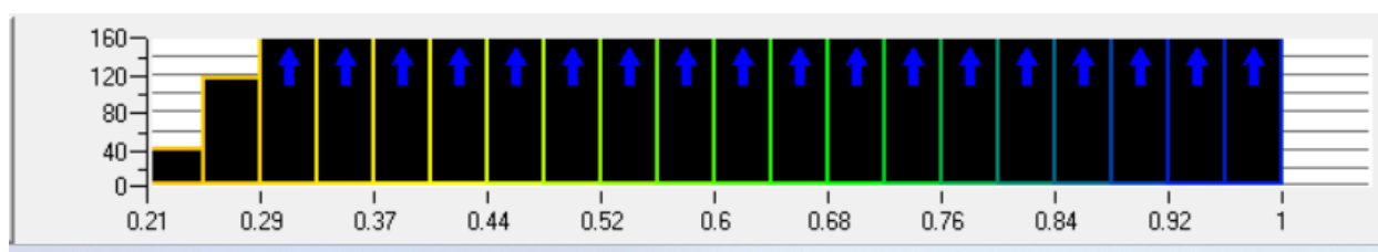
Рисунок 4 – Качество сеточной модели на 3 млн ячеек
