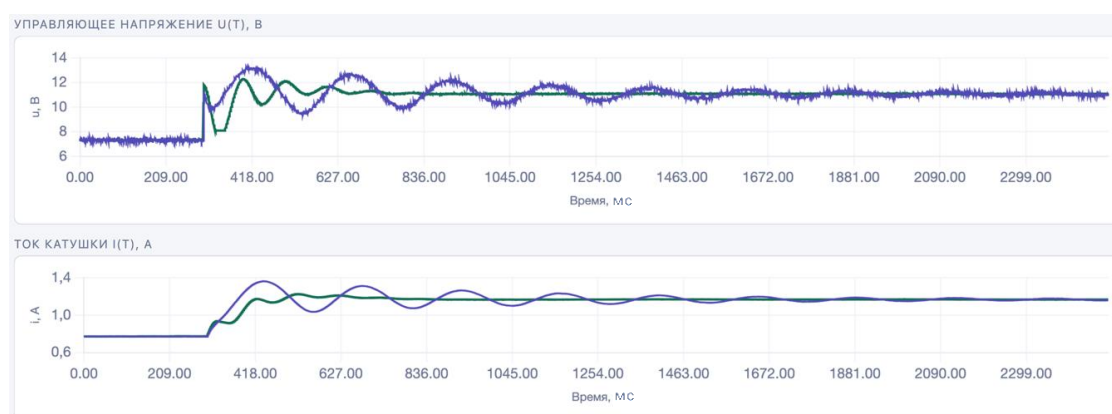
Рисунок 2. Графики переходных процессов U(t) , I(t) (скачок уставки +50%)
