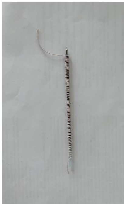
Рисунок 3 – Намотка провода на стержень диаметром 1,5 мм
