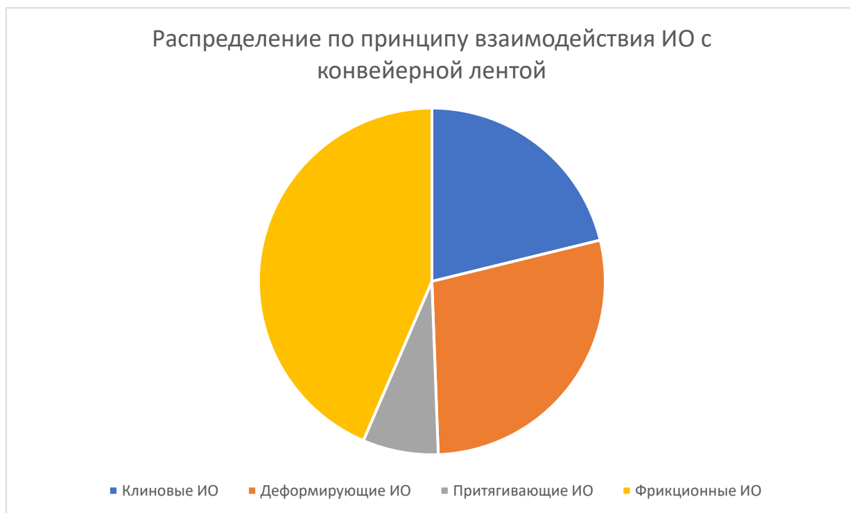
Рис 1 – Диаграмма распределения количества конструктивных решений по принципу взаимодействия ИО с конвейерной лентой
