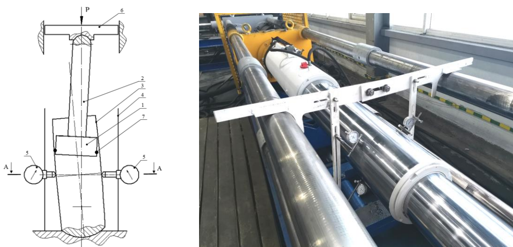
Рис. 2. Схема определения перекосов и деформаций рабочего цилиндра и стенд
