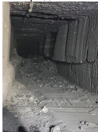
Рисунок 4 - Отклонение комплекса при проведении камеры и подрезка междукamerного целика
