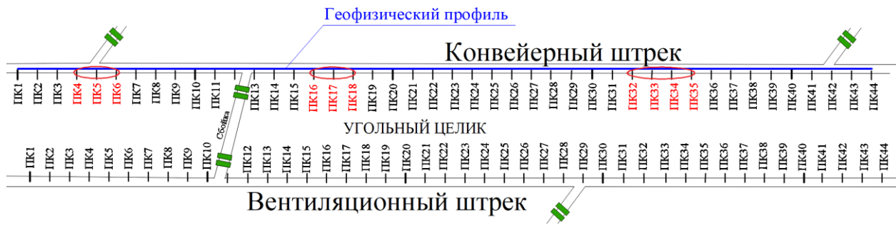
Рисунок 2. Предполагаемые зоны эндогенной пожароопасности вдоль геофизического профиля
