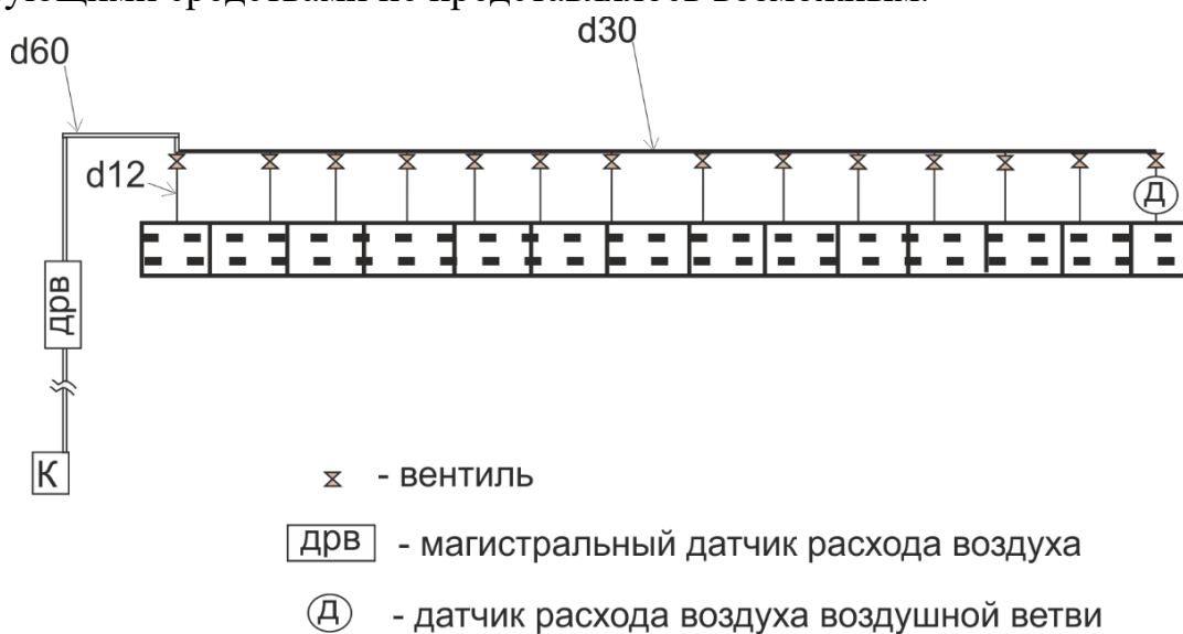
Рисунок 4 – Схема проветривания нижней (холостой) ветви лавного скребкового конвейера
