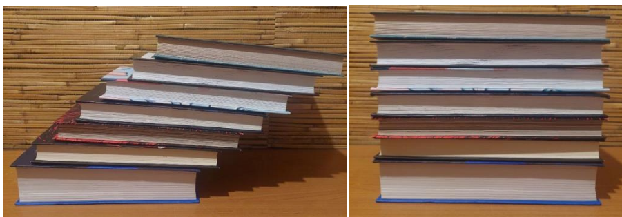
Рис. 6. Модель Пизанской башни из книг: башня под критическим углом \theta (слева); башня под углом в 90^\circ к основанию, в полном равновесии (справа).
