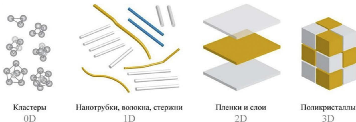
Рис. 1. Типы наноструктурированных материалов по размерности: 0D – нульмерные, 1D – одномерные, 2D – двумерные, 3D – трёхмерные
