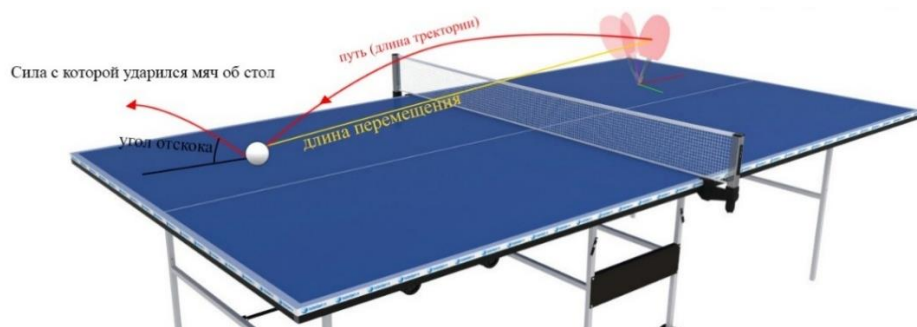
Рисунок 4 Измерение параметров отскока мяча
