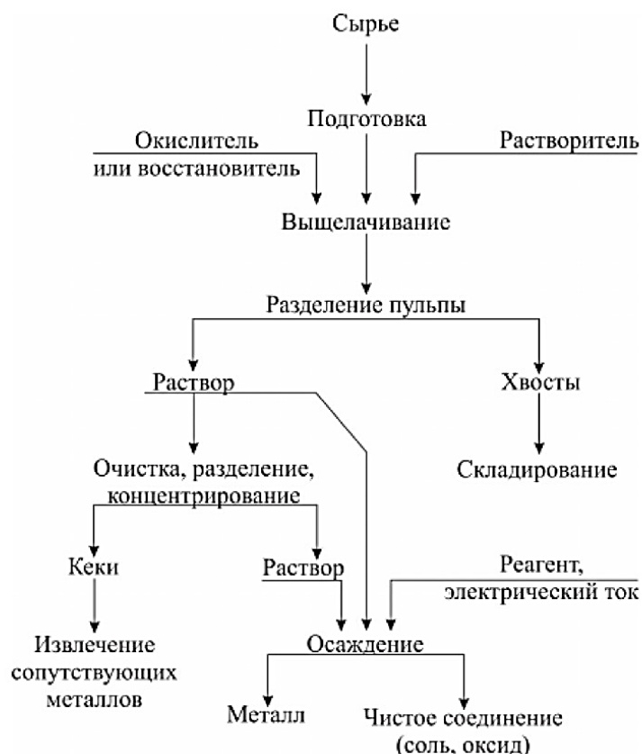
Рисунок 4 – Принципиальная схема переработки сырья по гидрометаллургической Технологии
