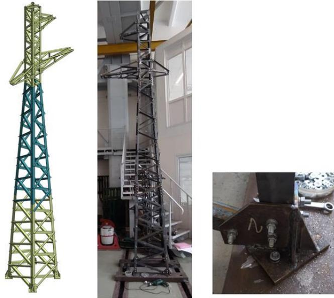
Рис. 2 Имитационная решетчатая модель: слева – геометрическая модель; по центру – реальная конструкция; справа – пример опорного узла
