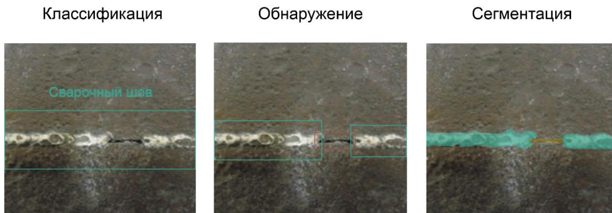
Рис. 1 Результаты работы СНС для изображения сварочного шва
