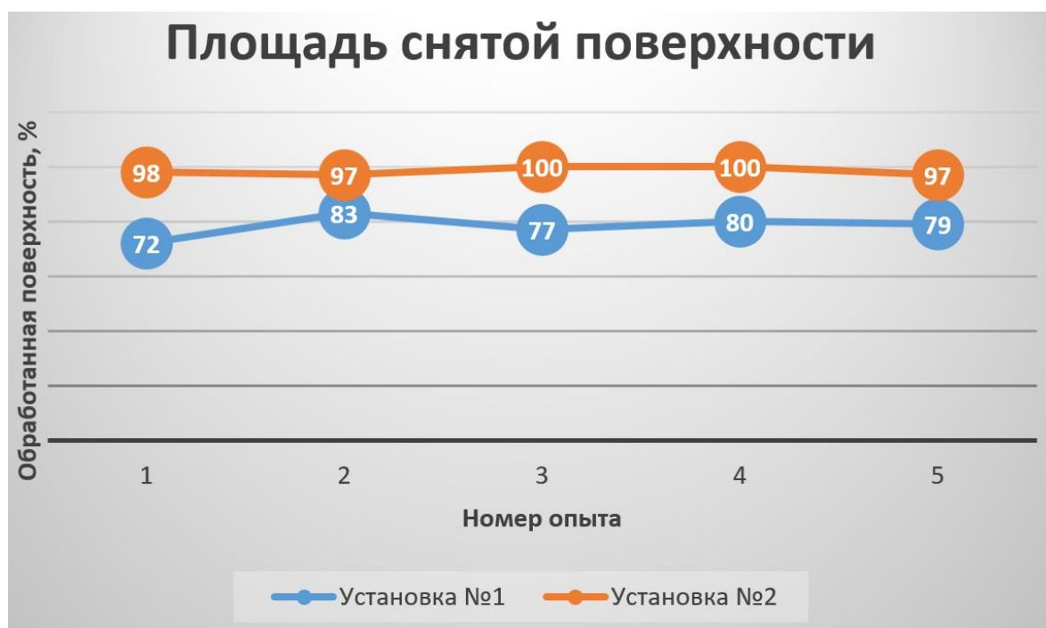
Рис. 7. Результаты оценки площади обработанных поверхностей.
