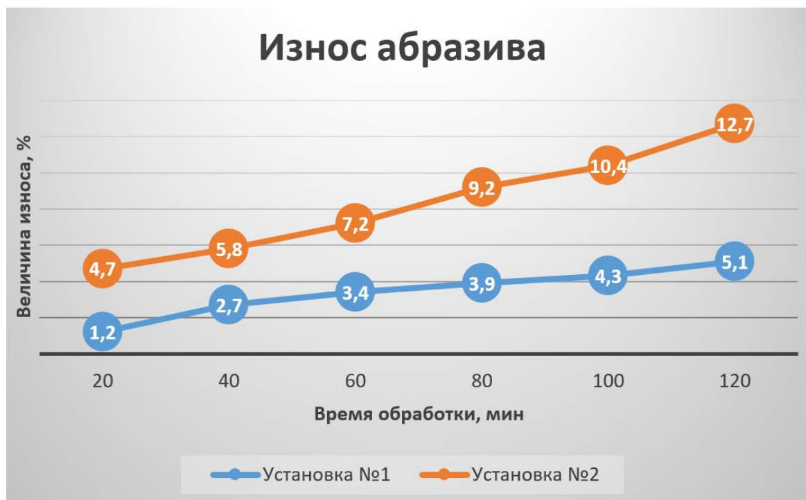
Рис.6. Результаты оценки износа абразива.
