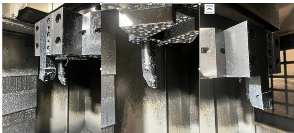
Рис. 4. Проходные и расточные резцы со сменными пластинами, установленные в револьверную голову станка модели LCK850
