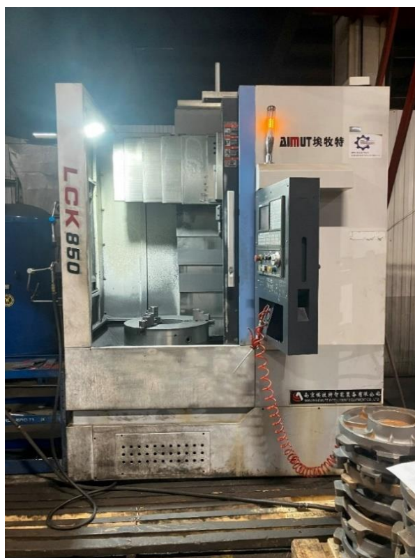
Рис. 3. Вертикально-токарный станок модели LCK850 и литые заготовки подшипниковых щитов
