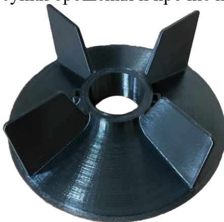
Рисунок 5 Крыльчатка охлаждения электродвигателя, изготовленная на 3-D принтере
