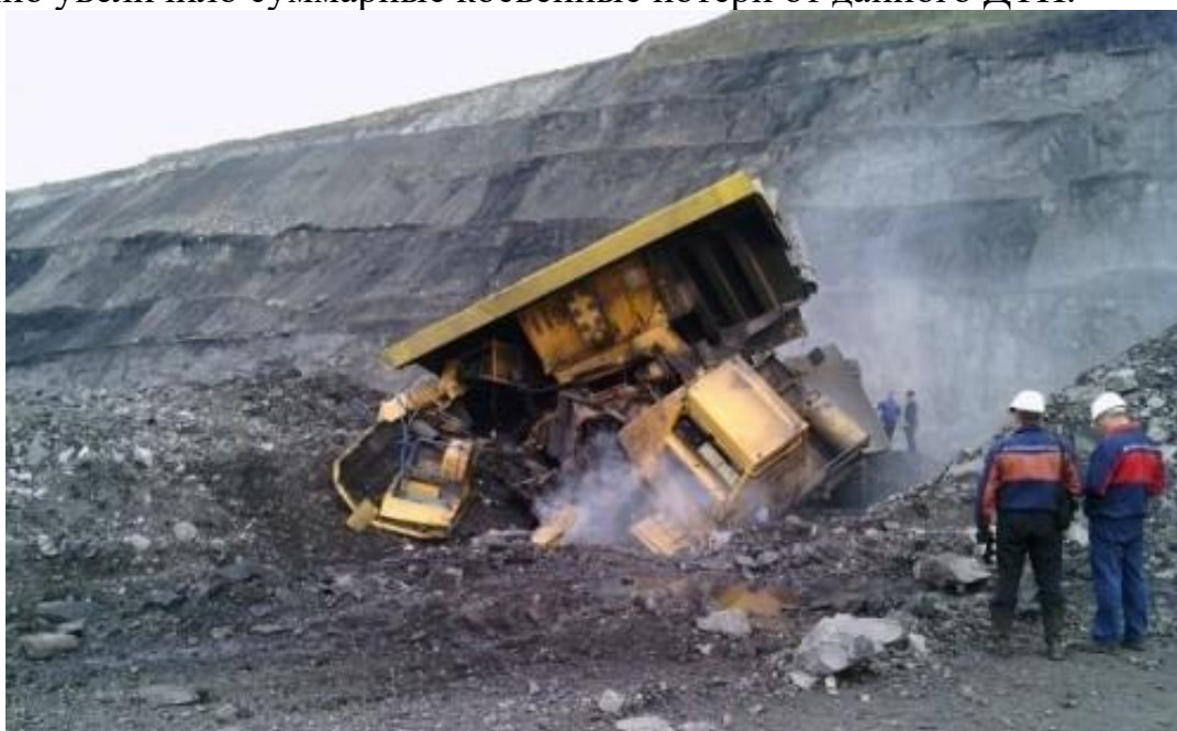
Рисунок 1 – Последствия ДТП при отказе тормозной системы
