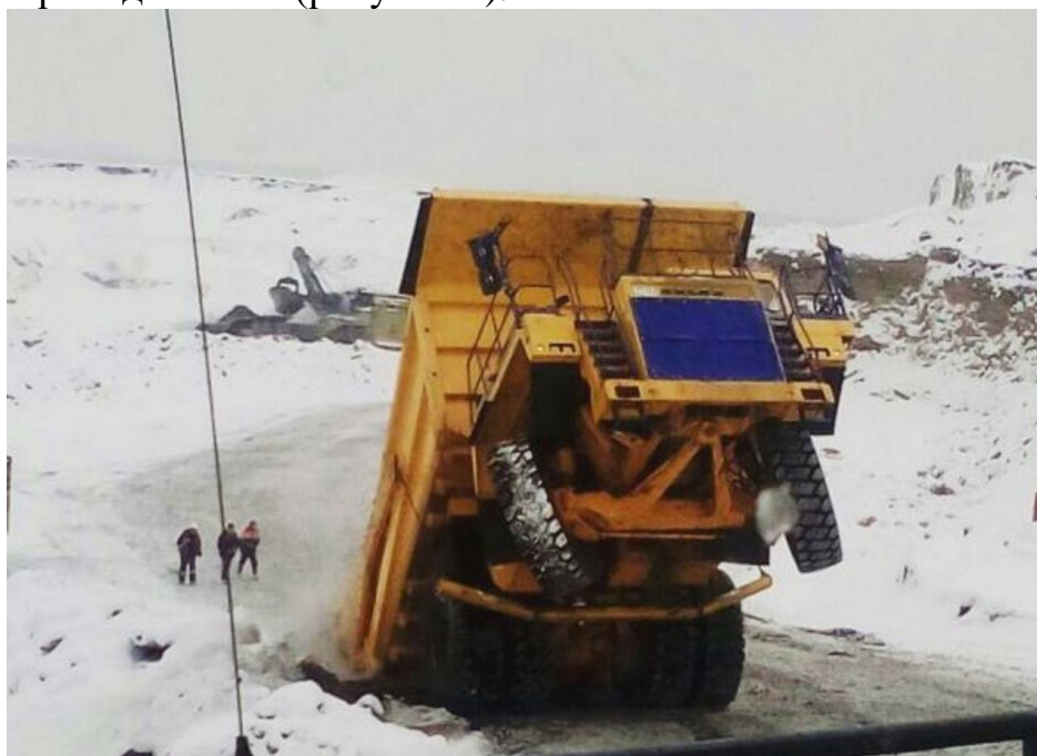
Рисунок 4 – Опрокидывание карьерного самосвала при нарушении технологии его загрузки
