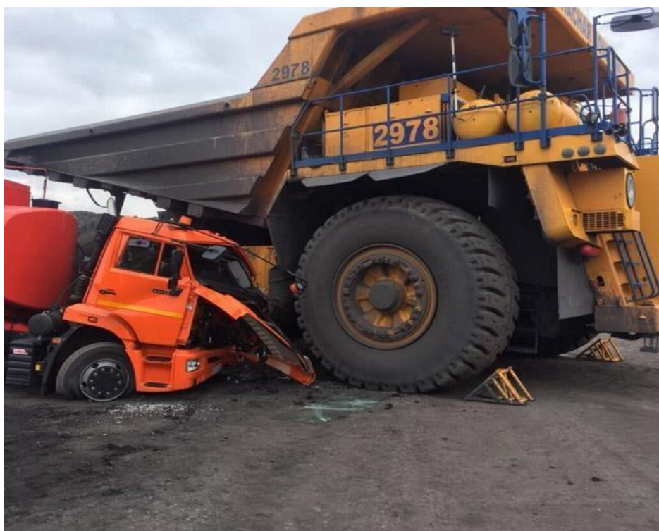
Рисунок 3 – Последствия наезда карьерного самосвала на бензовоз
