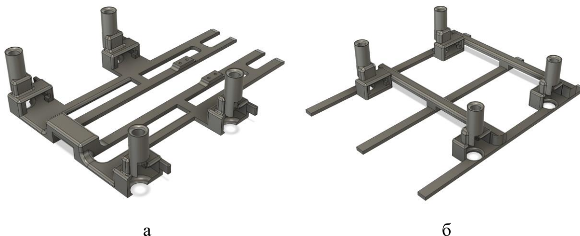
Рис. 3. Рамы передовой и отстающей секций масштабного макета МШК: а – рама передовой секции, б – отстающей
