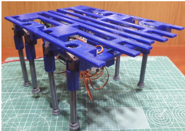
Рис. 4. Функциональный макет МШК в масштабе 1:20
