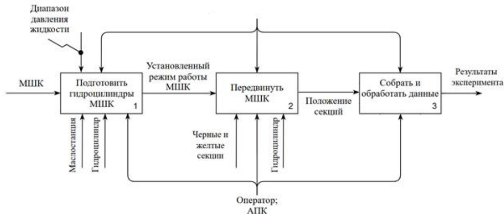
Рисунок 2 – Работа системы управления МШК по стандарту IDEF0
