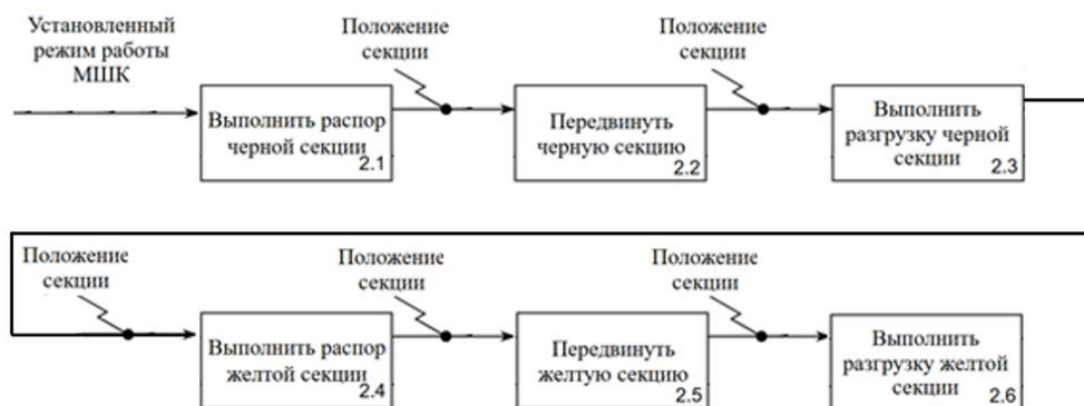
Рисунок 3 – Процесс передвижки МШК
