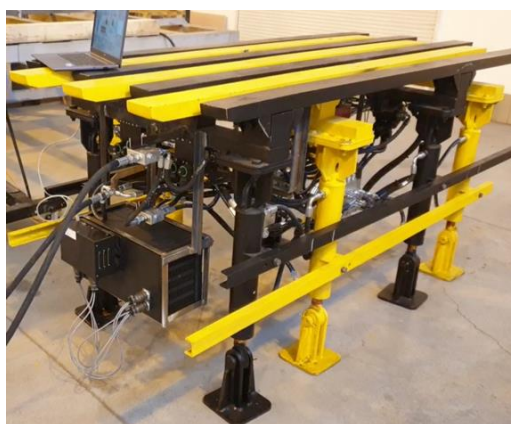
Рисунок 1 – Масштабный макет механизированной шагающей крепи
