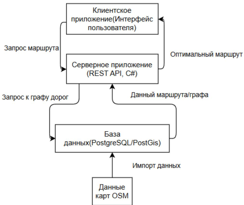
Рис. 1. Архитектура системы оптимального построения маршрута.
