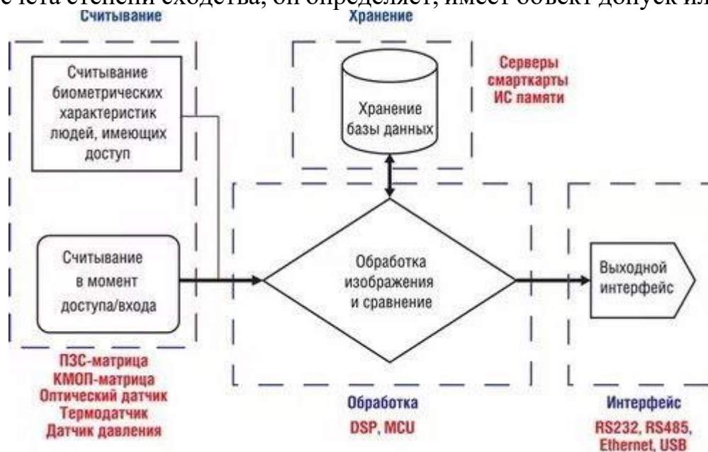
Рисунок 2 - Структурная схема статических биометрических систем
