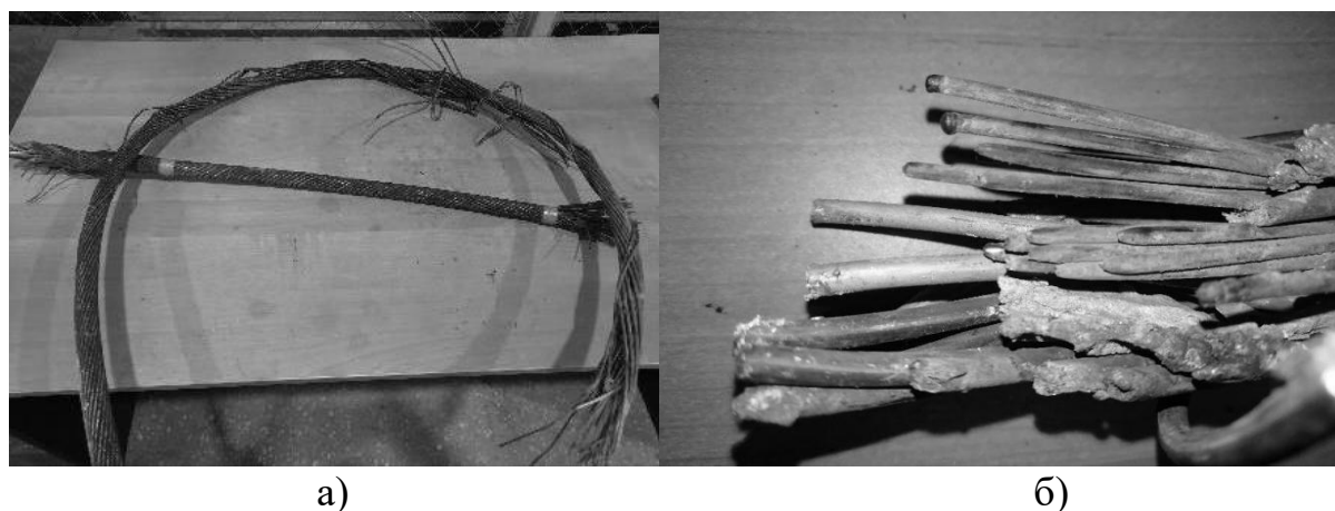
Рисунок 1– Образцы провода АСУ300: а) до разрыва; б) после разрыва
