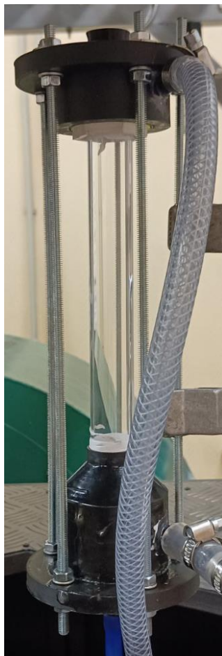
Рисунок 1 – Противоточное вихревое горелочное устройство, закрепленное на стенде
