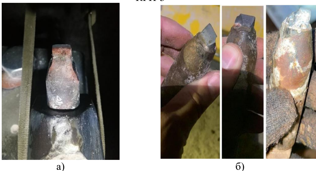
Рисунок 3 – Вид износа: а) равномерный износ; б) поломка твёрдого сплава Модернизация конструкции резца
