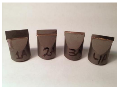
Рисунок 6 – Армирующие вставки со сверхтвёрдым сплавом КНБ [5]
