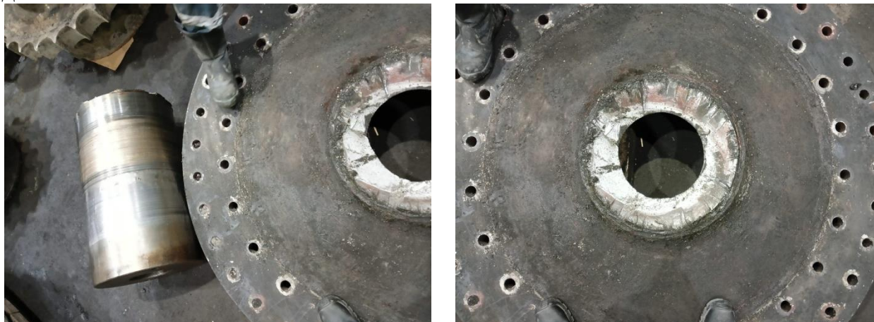
Рисунок 3 – Сломанная центральная цапфа экскаватора-драглайна
