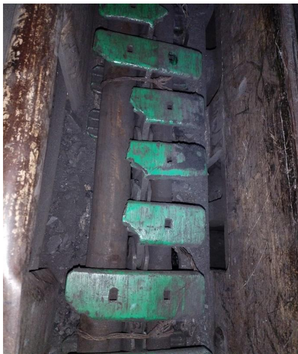
Рис. 2. Повреждения полок звеньев кабелеукладчика
