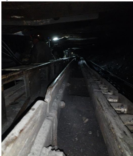
Рис. 5. Забойный скребковый конвейер: а – базовое исполнение; б – с демпферной лентой
