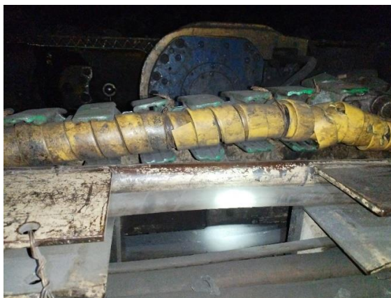
Рис.4. Дополнительная защитная оплетка кабеля
