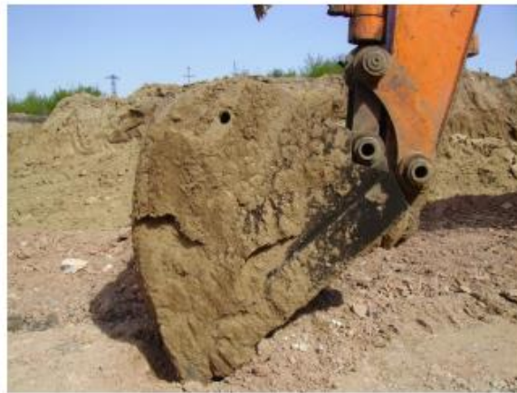
Рисунок 2 – Налипание пород на внешнюю сторону ковша [5]
