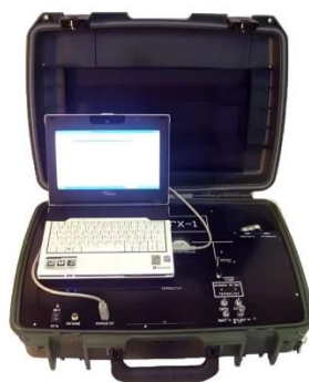
Рис. 2. Портативный хроматограф для определения метана в шахте
