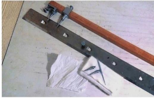
Рис. 6. Линейка Дробышева — инструмент (линейка) для точного построения ортогональной координатной сетки
