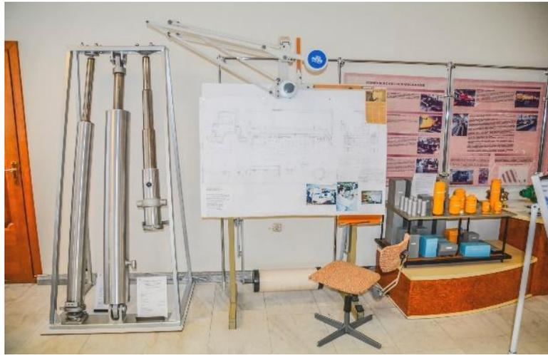
Рис. 2. Кульман — чертёжный прибор пантографной системы в виде доски, установленной вертикально или под углом
