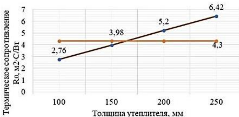
Рисунок 5. - Результат расчета требуемого термического сопротивления в зависимости от толщины принятого утеплителя:
